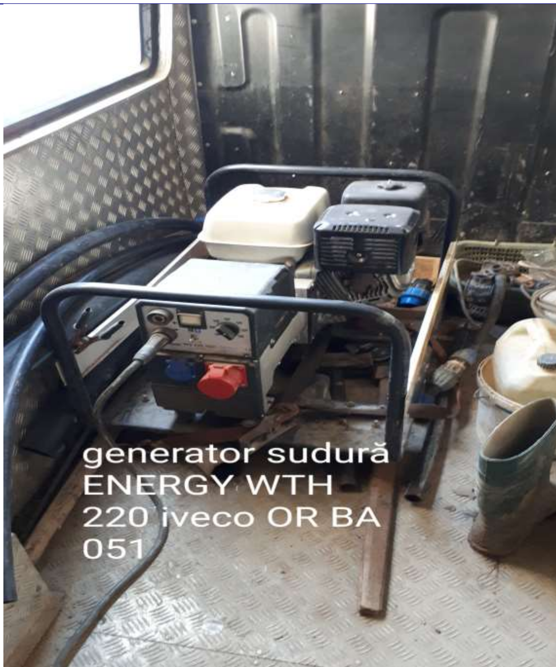
Imaginea nr. 9. Generator instalat pe mașina IVECO 051.
